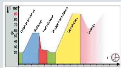
fig.3 Ejecución de programa esquemática del programa Vario TD
